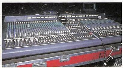
▲メイン・コンソールはYAMAHA PM4000。1~9chがドラム、10chがベースと順に立ち上げられていたが、何とキーボードの森は11~24chの計14chを1人で使用。卓の右上PCは、LinearX pcRTAという測定用のアナライザを動かすためのマシンだ
